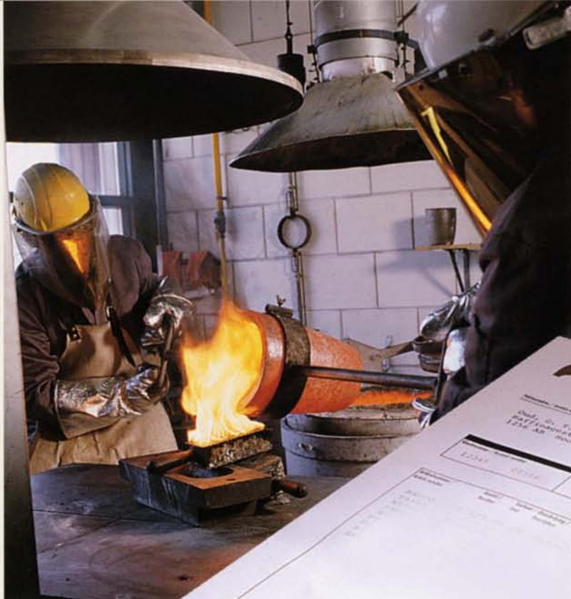
Uitgieten van het gesmolten materiaal
